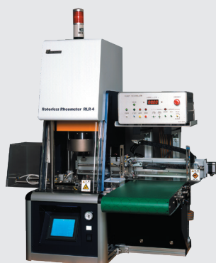
ピン式試料自動着脱装置 型式 ROB-R4 試料数最大84個
