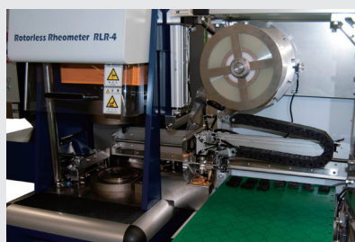
フィルム式試料自動着脱装置 型式 ROBF84 試料数最大84個
