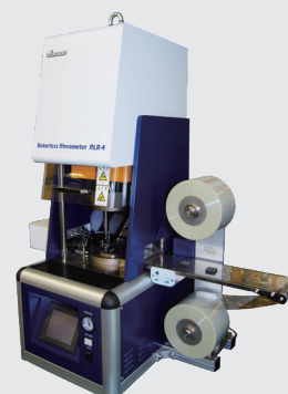
フィルム式試料自動着脱装置 型式 ROBF06 試料数最大6個
