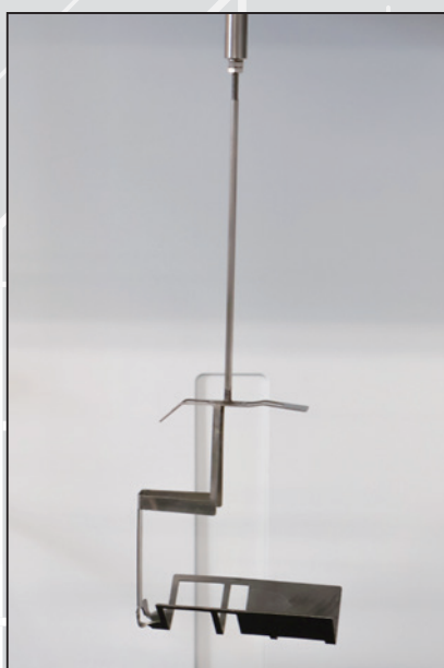
▲全自動比重計専用液中クランプ
