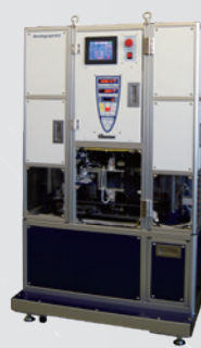
No.509 バンドグラフ 全自動曲げ試験機
