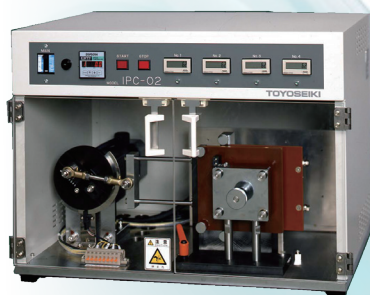
▲ FFC・FPC 等の摺動疲労強度試験 No.674 IPC 屈曲試験機
