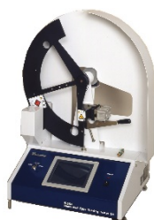
No. 164 デジタルエルメントルフ 引裂試験機
