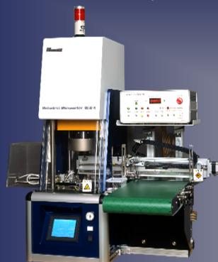
ピン式試料自動着脱装置
