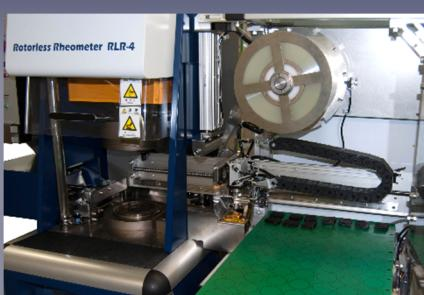
フィルム式試料自動着脱装置
