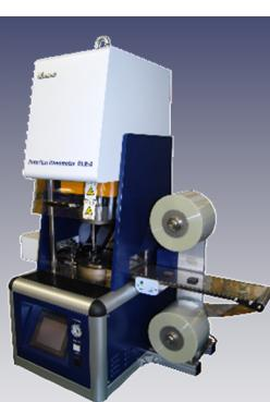
フィルム式試料自動着脱装置
