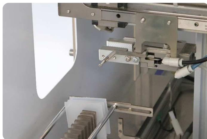
▲試験片搬送ハンド エアーシリンダおよび 電動式アクチュエータで駆動します。
