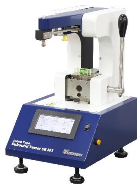
No.232 ショブ式反発弾性試験機 型式 SB-M1
