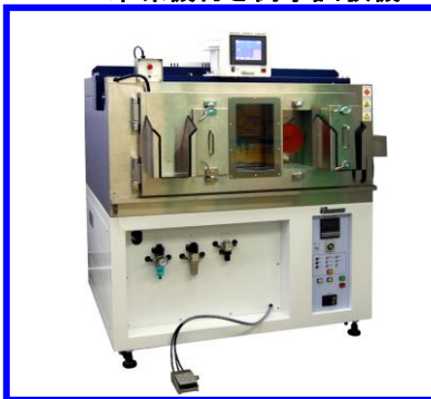
No.526 冷凍機付き衝撃試験機
