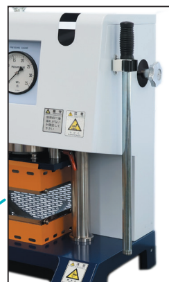
▲使用しないときは、加圧ハンドルを本体側面のキャッチャーに固定可能
