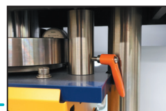
▲ストローク可変設定器 上部熱盤の上限位置を任意に設定可能
