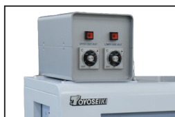
▲独立過昇温防止ユニット
