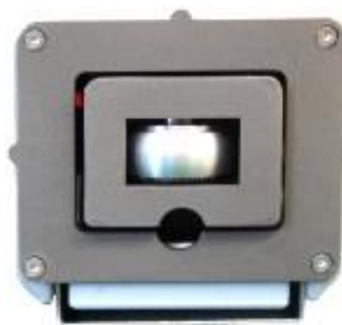
Sekcja pomiarowa (Aluminum R ring, model AL-R1)
